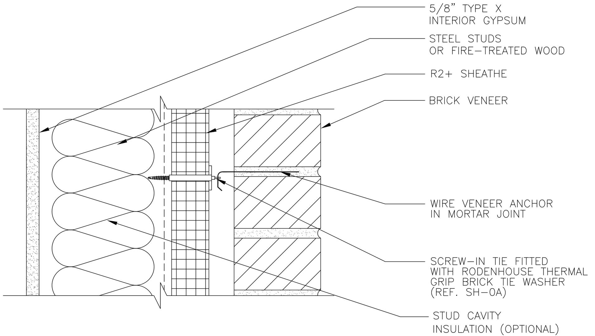
DETAIL IS INTENDED TO BE A GUIDE FOR INSULATION
